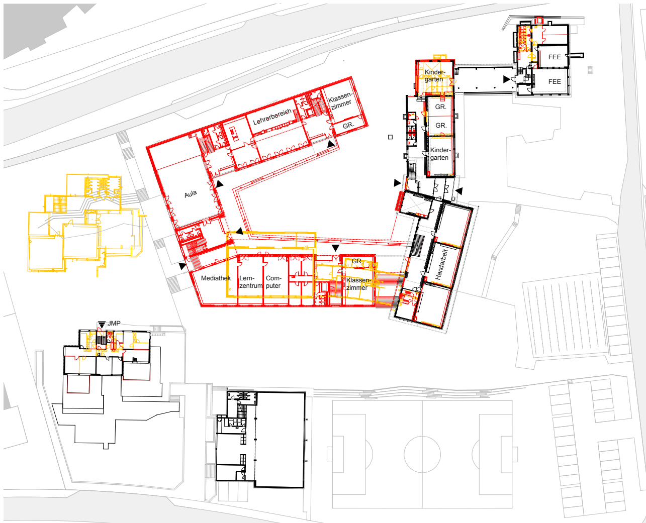
Abb. 5: Erdgeschoss: Gebäude A: Aula, Mediathek, Computerraum, Schulleitung, Lehreraufenthalt. Gebäude B: Kindergarten, Handarbeit, Gebäude C: Tagesbetreuung, Gebäude E: Jugendmusikschule (Planstand Bauprojekt 2014)
