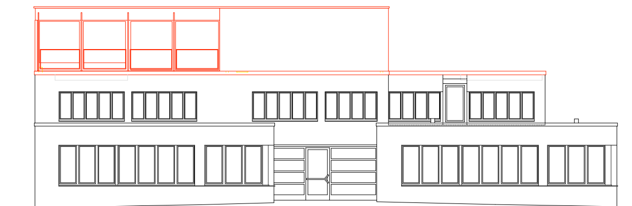
Abb. 15: Südfassade: Gebäude E/Hauswartwohnung (Planstand Bauprojekt 2014)
