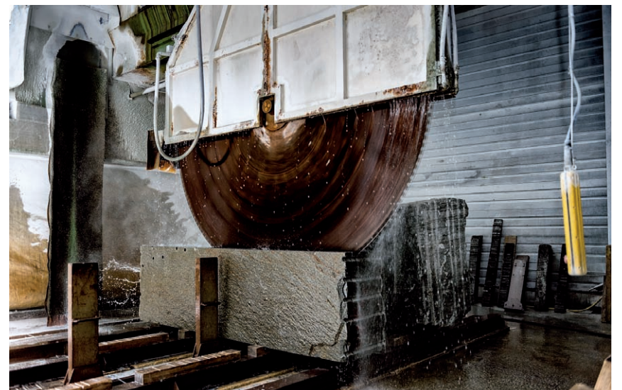
Zuschneiden der Felsblöcke im Werk der Toscano Naturstein AG in Andeer.
